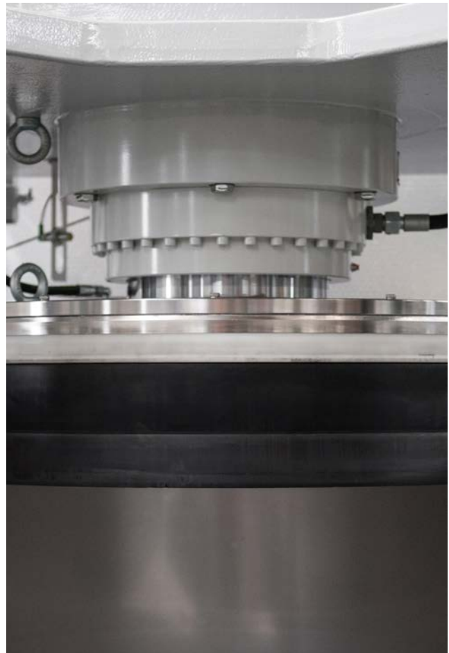
2K Presspolster mit verlängerter Lebensdauer
